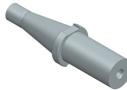
Nous devons donc réaliser un *Extrude subtract* comme présenté dans l'exercice précédent. Il faut tracer, conformément au plan, un rectangle de 16,1 mm sur 8 mm à 16,2 mm du plan de symétrie puis appeler la fonction *Extrude*. Malheureusement, le module d'esquisse (*Sketch*) a besoin d'un plan pour y dessiner le rectangle de 16,1 x 8 mm et celui-ci doit être à 16,2 mm du plan XY.
